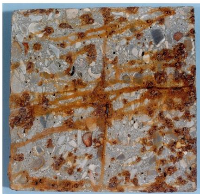
Béton contenant des fils d'acier Aspect après 3 mois
